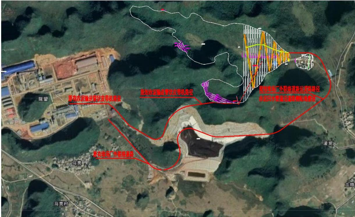
图 3.2-4 赤泥运输及回水路径示意图
